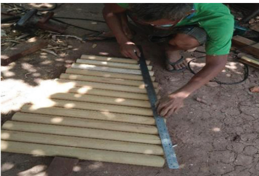
ภาพที่ 7 การใช้ไม้บรรทัดยาววางทาบลูกโป่งกลาง และนำดินสอขีดลากเส้น
