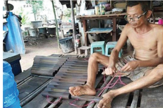
ภาพที่ 10 การร้อยเชือกเข้าไปในรูที่เจาะ และใช้เท้าทั้งสองข้างดันลูกโปงกลางไว้ให้ตึง
