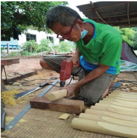
ภาพที่ 9 การเจาะรูร้อยเชือกด้วยสว่านขนาด 2 หุน
