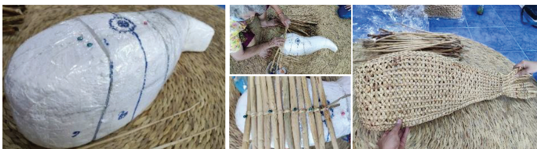
รูปที่ 4 โครงสร้างแม่แบบก่อนการสานผักตบชวา และการขึ้นรูปโคมไฟโดยสานผักตบชวา
