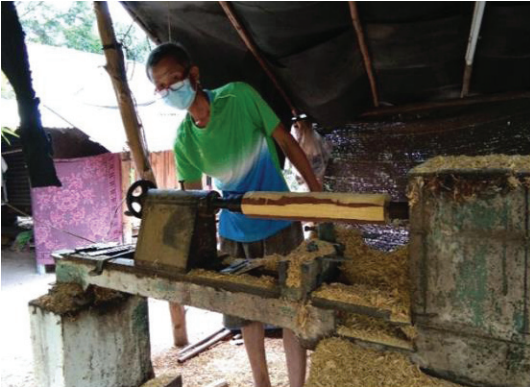
ภาพที่ 6 การนำไม้มาจัดเรียงขึ้นไว้ที่แท่นกลึง และเปิดใช้งานเครื่องกลึง
