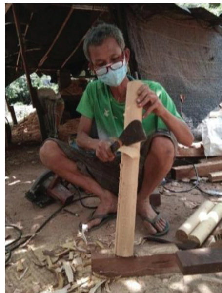
ภาพที่ 8 การใช้มีดโต้ที่มีความคมถากเหลาบางๆ ออกทีละน้อย
